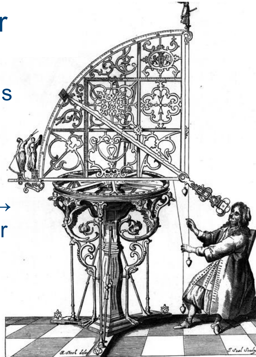
Crüger's großer Azimuthal-Quadrant, vollendet von Hevel 1644, nach Hevel's Machina coelestis.
